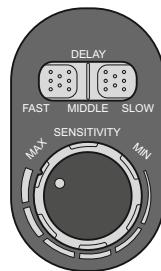
Operatorul are posibilitatea de a ajusta durata de întârziere a schimbării filtrului de la închis la deschis folosind comutatorul cu trei poziții **INTÂRZIERE/DELAY** amplasat pe carcasa căștii, lângă butonul de ajustare a sensibilității – **SENSIBILITATE/SENSITIVITY**. Acest comutator permite ajustarea în salt a duratei de reacție a filtrului: **FAST** – 0,1-0,2s/ **MIDDLE** – 0,2-0,5s/**SLOW** – 0,5-0,8s.
